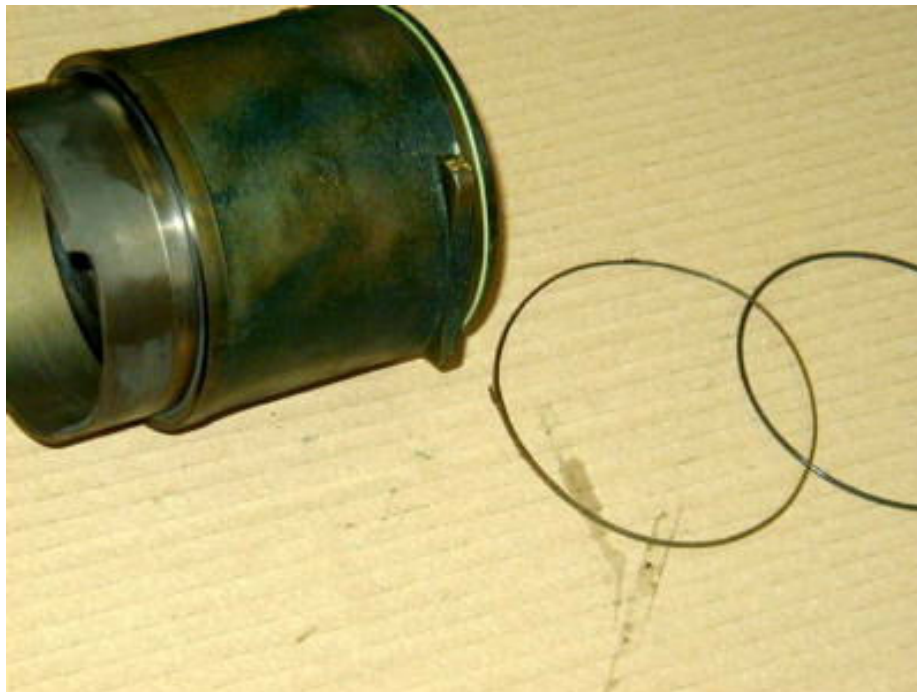
Folgend zu sehen der zu ersetzende grüne und schwarze Dichtring, und die fertige Zylinderlaufbahn mit den neuen Dichtringen.
