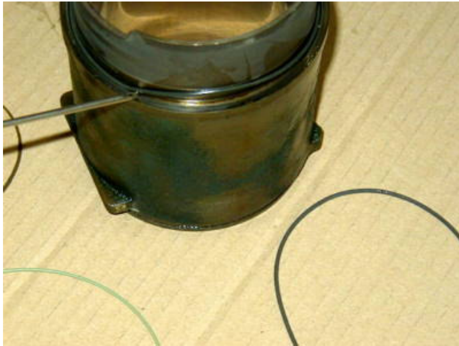
Am Zylinderfuss sitzt der schwarze Dichtring.
